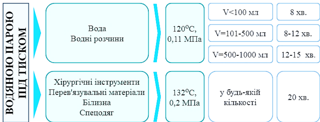
Рис. 11.9. Основні параметри стерилізації водяною парою під тиском [джерело: власна розробка]
