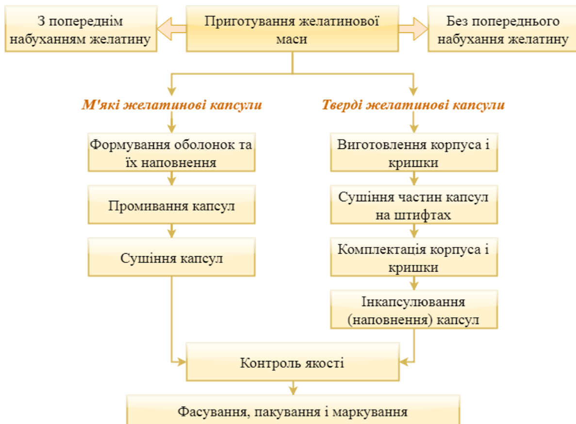
Рис.6.7. Схема технологічного процесу отримання желатинових капсул [джерело: 2]
