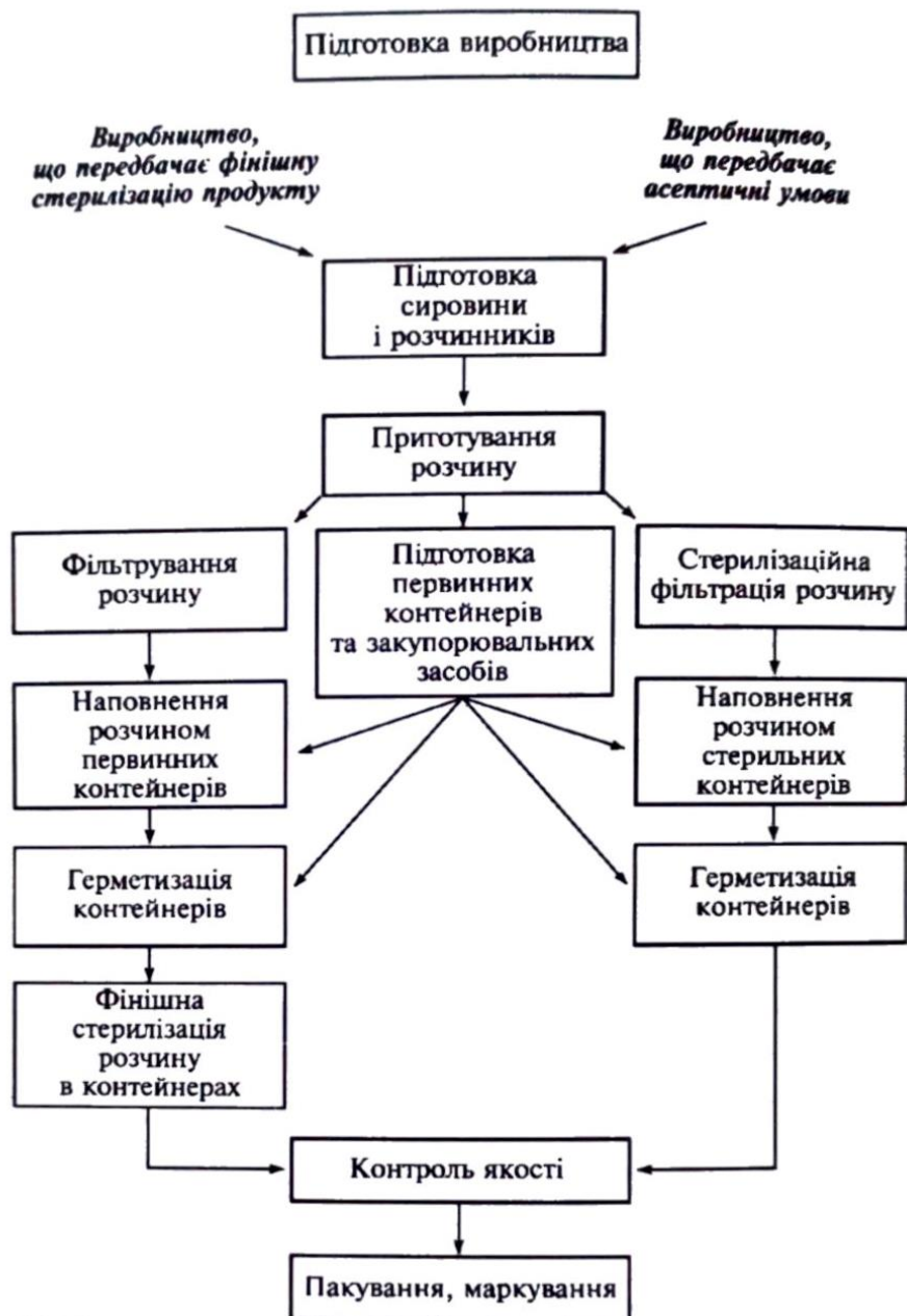
Рис. 5.9. Схема технологічного процесу виробництва стерильних препаратів для парентерального застосування [джерело: 5]
