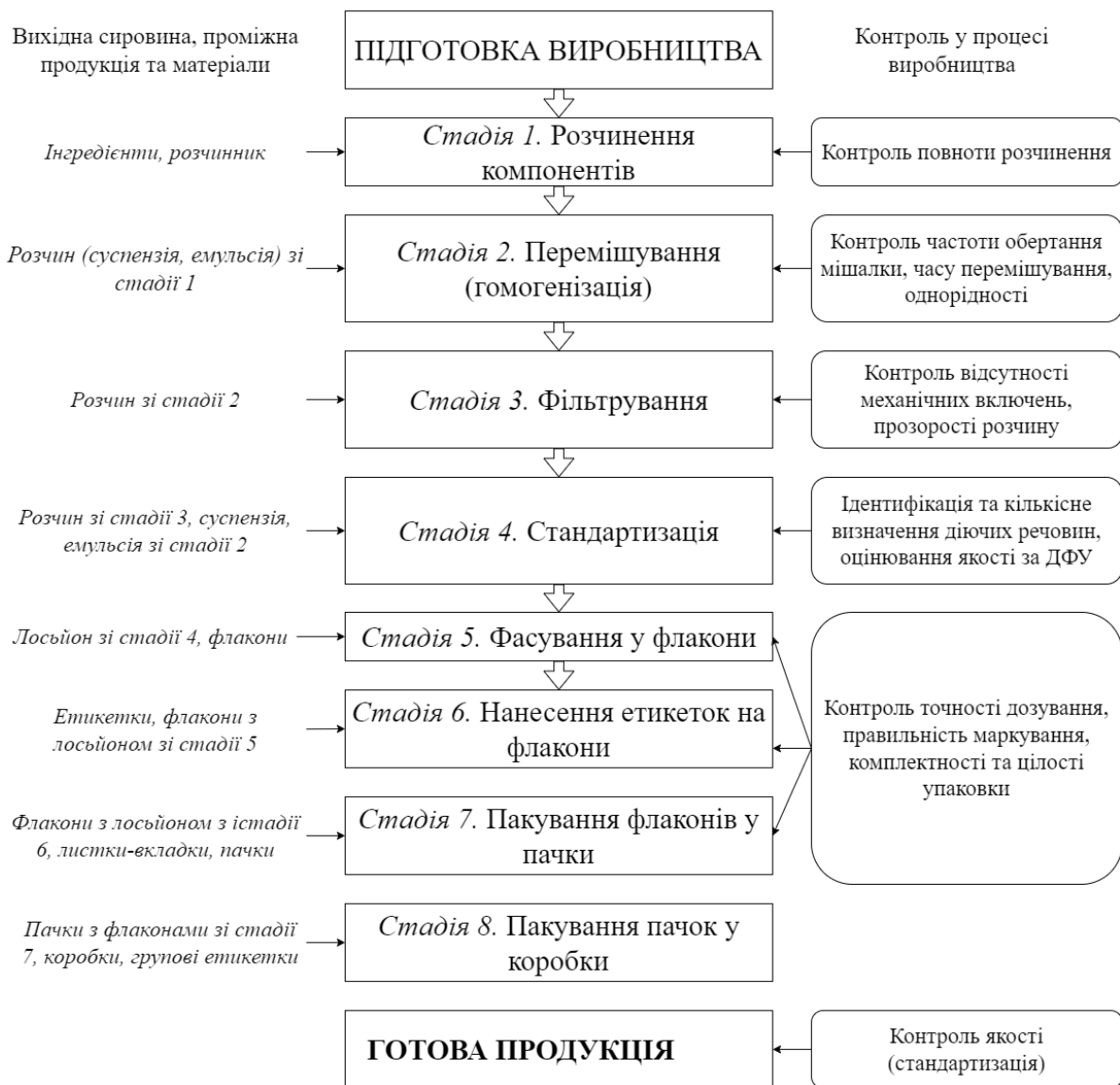
Рис. 1.14. Технологічна схема виготовлення лосьйонів [джерело: 21]
