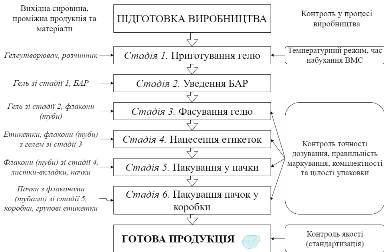
Рис. 2.18. Технологічна схема промислового виробництва гелів [джерело: 30]
