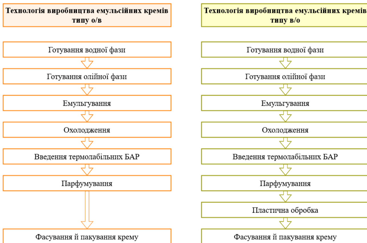
Рис. 2.24. Технологічні стадії виробництва емульсійних кремів [джерело: власна розробка]
