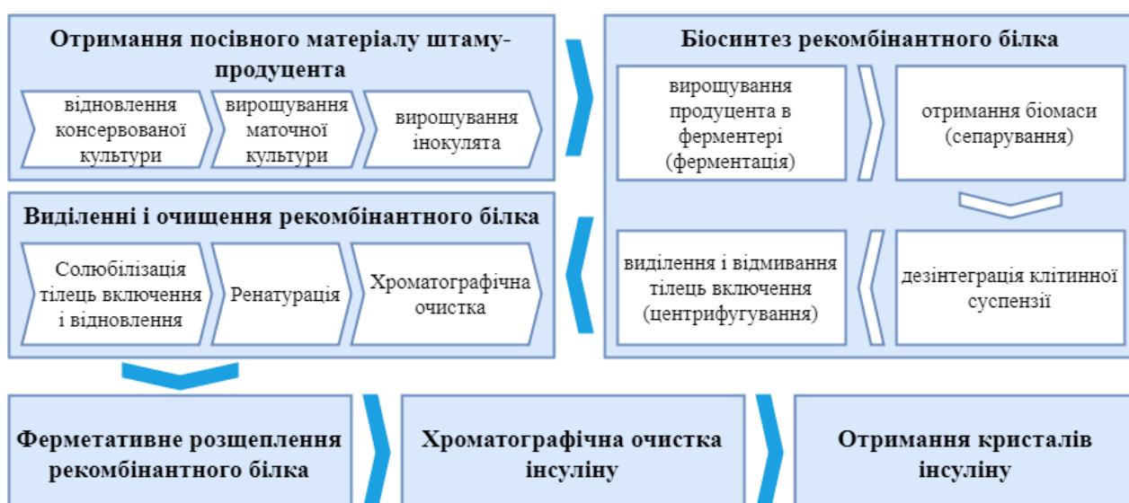
Рис. 4.8. Технологічна схема отримання інсуліну
