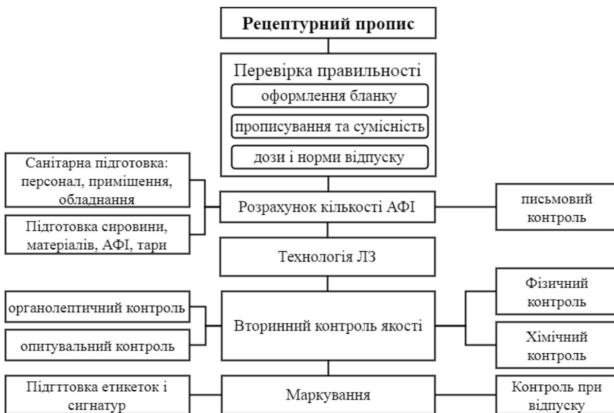
Рис. 4.3. Принципова схема виготовлення стерильних та асептично виготовлених лікарських засобів в умовах аптеки
