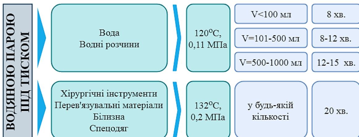
Рис. 4.7. Основні параметри стерилізації водяною парою під тиском
