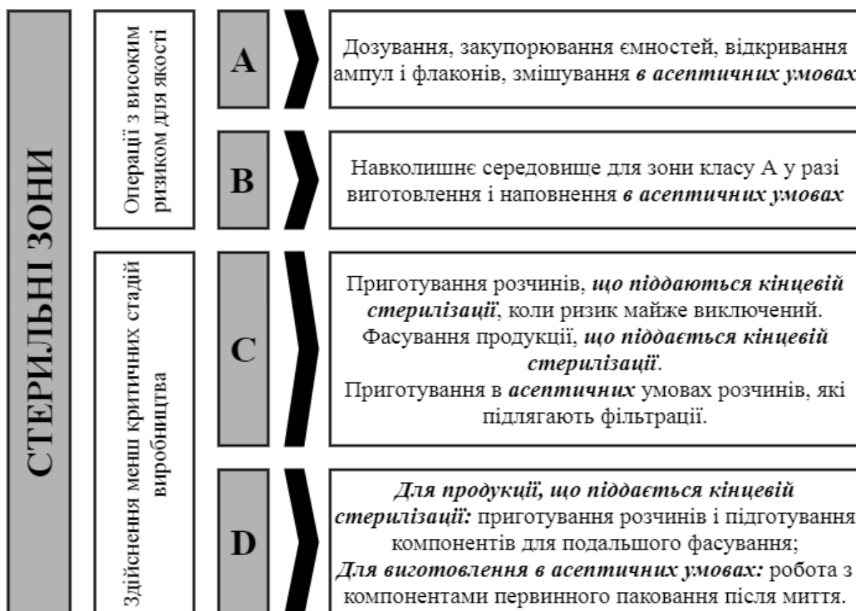
Рис. 4.1. Стерильні зони та приклади операцій, що у них проводяться
