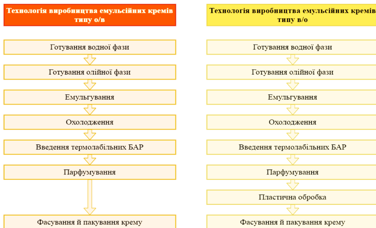
Рис. 7.3. Технологічні стадії виробництва емульсійних кремів
