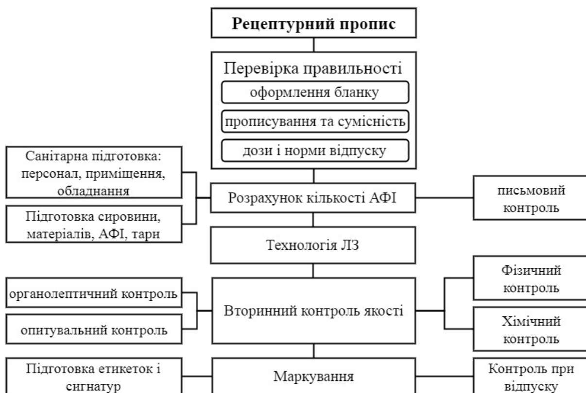
Рис. 5.1. Принципова схема виготовлення стерильних та асептично виготовлених лікарських засобів в умовах аптеки [джерело: 2]
